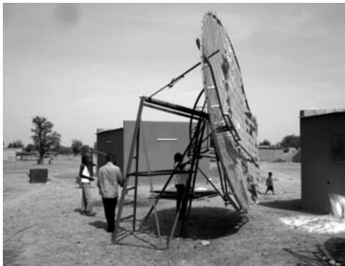
FIGURE 2. CAPTEUR PARABOLIQUE HÉLIOTHERMIQUE POUR LA TRANSFORMATION DES NOIX DE KARITÉ. CONÇU PAR ISOMET À DABARÉ (BURKINA FASO). PHOTO DE GREGORY MILLER. SNV. (ENDNOTES)
