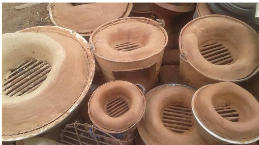
**Figure 14: Foyer métallique en seau ou bassine à insert en argile**
